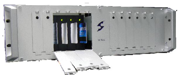
Questo SCBox può contenere da un minimo di una ad un massimo di 12 smart card. La SCBox contiene al suo interno le smart card che utilizza, sia per ragioni di sicurezza che in ottemperanza al Codice dell'Amministrazione Digitale. Un Appliance  $\alpha$ PeS™ 2D-Plus® può gestire fino a quattro SCBox.
