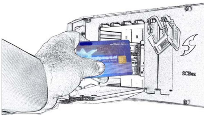
**Le Smart Card vanno inserite con il chip rivolto verso il lettore e la faccia contenente il chip rivolta verso il lato destro dell'SCBox™ (vedi figura laterale)**
